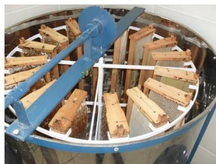
**Figura 6 – Extração de mel com uso de centrífuga**
